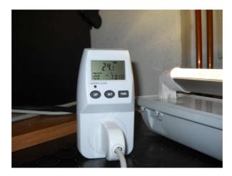
Il consumo della plafoniera trasformata ad accogliere 4 tubi a led da 60 cm è di quasi 39 watt. Anche in questo caso, il consumo, confrontato con l'equivalente soluzione al neon, è più che dimezzato.
