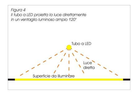
Il risultato è quindi che la luce prodotta di 76 lumen/watt è già orientata a destinazione senza la necessità di meccanismi di rifrazione/riflessione che ne ridurrebbero l'efficienza. Il valore è ricavato dalla scheda tecnica del tubo a LED utilizzato "RMS-T8AA600-10W" come rapporto tra il flusso luminoso generato (765 lumen) ed il consumo elettrico (10 watt).
